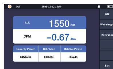
7. Optical Loss Test / Test des optischen Verlusts
