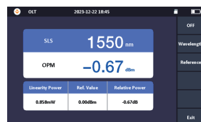
7. Medidor de Pérdida Óptica / Optical Loss Test
