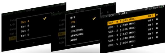
Mit dem Gerät können die Parameter konfiguriert werden, die für den Empfang seines Satellitenkanals nötig sind. Es unterstützt DiSeqC- und dCSS/SCR-Schaltbefehle.
