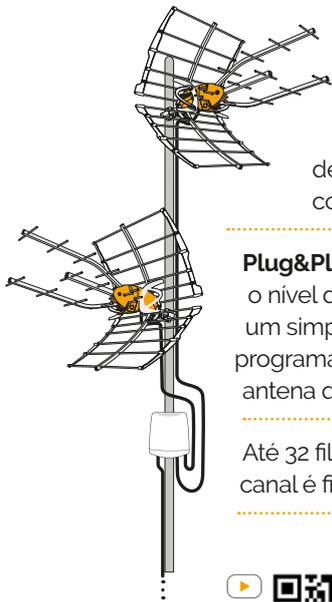
Dispositivo **"All in one"**: combina as funções de vários elementos de uma instalação, como filtros, misturadores e amplificadores, disponibilizando uma distribuição de sinal completa sobre um único cabo coaxial.
