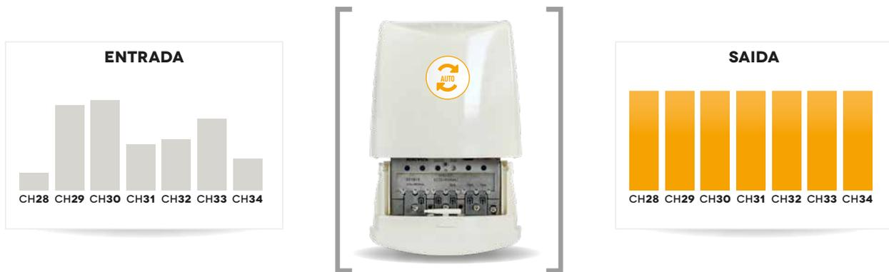
A função de autoprogramação do SmartKom oferece ao equipamento a possibilidade de se programar e ajustar de forma totalmente automática. Ao pressionar o referido
