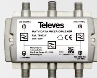
Dieses passive Element kann an beliebiger Stelle in der Koaxialanlage installiert werden, um die Signale vom terrestrischen TV und Satellitenempfang (290 bis 2400 MHz) vom Datensignal (1 bis 200 MHz) zu trennen und unabhängig zu verwalten (hauptsächlich zur Verstärkung).
