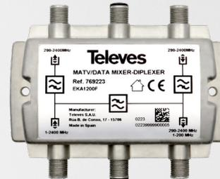
Cet élément passif peut être installé n'importe où dans l'installation coaxiale, pour séparer les signaux de télévision terrestre et de satellite (de 290 à 2400 MHz), du signal de données (de 1 à 200 MHz), et pour pouvoir les gérer de manière indépendante (principalement pour l'amplification).
