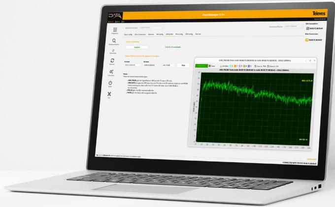
Contrôle et évolution dans le temps des paramètres du réseau RF : rapport signal/bruit (SNR), densité spectrale de puissance (PSD), plancher de bruit, etc.
