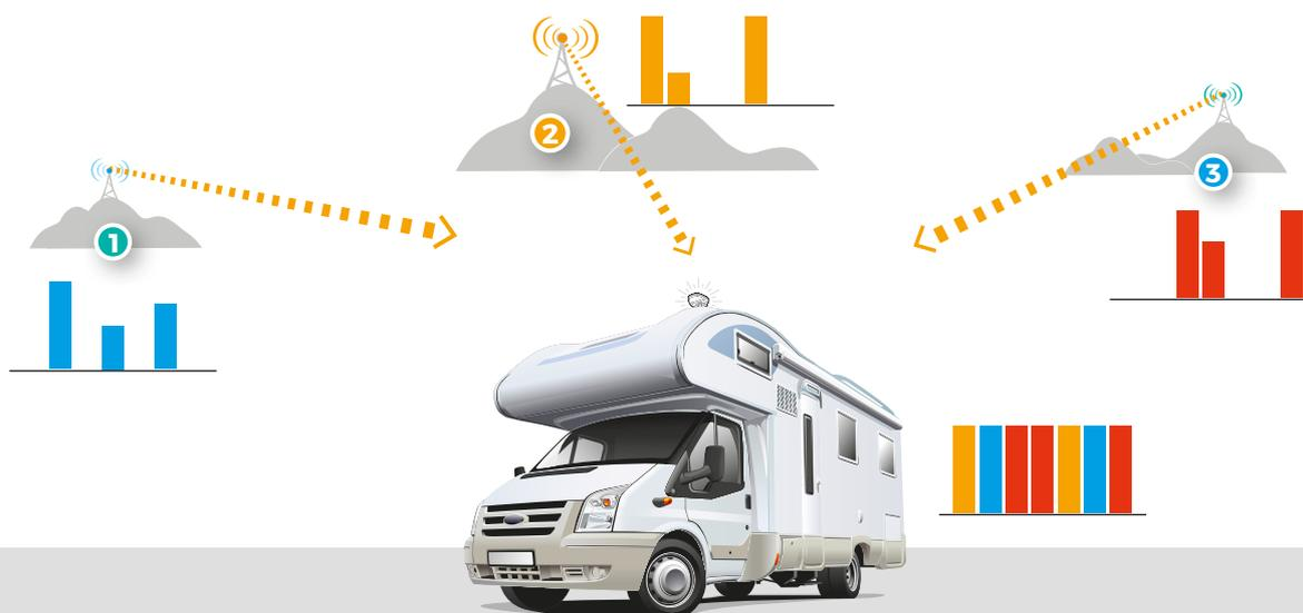
SmartNova capta sinais em simultâneo com as suas três subantenas direcionais dispostas em 120°, para que sejam recebidos sinais de diferentes transmissores no veículo. A inteligência da antena escolhe o sinal ideal entre os três em todos os momentos, entregando sempre um **sinal de qualidade independentemente da orientação** da antena.
