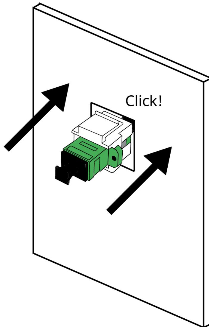
Zum Schluss, wenn die komplette Installation eingestellt ist, werden die Schutzkappen und Abdeckungen entfernt und das Patchkabel an die Steckdose angeschlossen.
