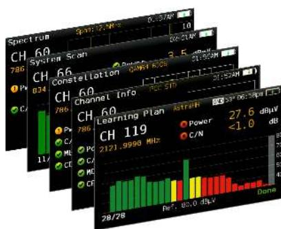
Fyllt med funktioner såsom: kanalmätning, konstellationsdiagram, spektrum analysator, programidentifiering, datalogg, autokonfigurerad kanalplan mm.
