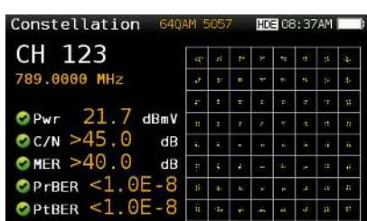
Konstellationsanalysen är ett grundläggande sätt för att bestämma kvaliteten på digitala signaler. Det bidrar till att lokalisera brus, jitter, störningar och signalmätnad, kort sagt alla de variabler som kan påverka bildkvaliteten negativt eller rent utav skapa bildbortfall. Genom att visuellt inspektera storlek och form i konstellationsmatrisen, kan man som tekniker enkelt identifiera bakgrunden till problemen.
