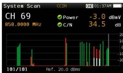
Med H30Flex är scanning i realtid enkelt, både av analoga och digitala kanaler. Detta gör det möjligt att i realtid bestämma den totala frekvensgången. Denna funktion ger verkligen en möjlighet att säkerställa signalparametrarna och påvisa att dessa uppfyller kabel-tv-nätets uppställda specifikationer genom en överskådlig grön, gul eller röd indikering. Det räcker med en snabb blick för att konstatera status på systemet, inkluderande BER- och MER-värden på den valda kanalen.
