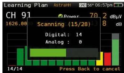
Hitta och identifiera kanalerna i ditt eget distributionsnät med den snabba "Capture Plan"-funktionen, och från där, bygg upp din egen mätplan i instrumentet med endast de kanaler du är mest intresserade av. Dessutom kommer du att se varje vald kanal i displayen med en "godkännandefärg", grönt, gult eller rött helt efter dina egna inprogrammerade kvalitetskrav.
