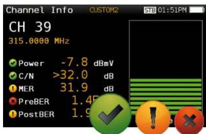
Det är enkelt att minimera installations-misstag med instrumentets Pass/Fail indikator, ett grafiskt verktyg för att snabbt skapa förståelse för mätresultatet. Flera olika nivåer finns att välja på för att definiera var "godkänt-värde" ska ligga, helt beroende på vad som ska mätas: huvudcentral, bredbandsförstärkare, nätverk, överlämningspunkter, lägenhet/villa, etc. Förutom ett antal fördefinerade värden, går det också att själv bestämma önskade värden för när signalen ska få status "godkänd".
