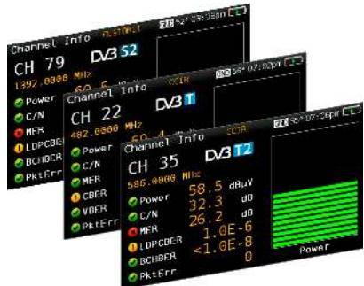
H30FLEX är förberett för varje användares speciella behov. Det är ett multi-standardinstrument, klart för mätningar inom satellitbandet, och det teresta bandet. För att möta användarens förändrade mätbehov, går det enkelt att ladda ned nya mätfunktioner och uppdateringar, normalt utan att behöva returnera instrumentet till fabriken.
