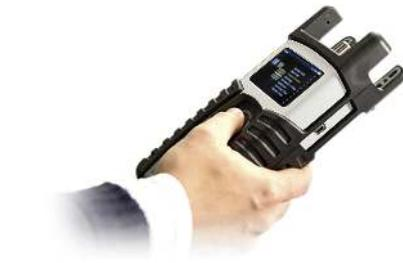
Sein exklusives Gehäuse aus Gummi mit doppelter Einspritzung und Polycarbonat-Kunststoff garantieren Schutz und eine lange Lebensdauer. Mit einem Gewicht von nur ca. 510 Gramm ist das H30FLEX leicht zu transportieren und handzuhaben. Man kann es in eine Tasche stecken oder mit dem Riemen über die Schulter hängen... Man merkt kaum, dass es da ist!
