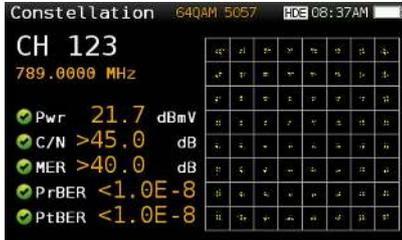
Das Konstellationsdiagramm ist unabdingbar für die Bestimmung der Qualität der digitalen Signale. Es hilft dabei, Brummen, Phasenjitter, Störungen und Signalsättigung zu erkennen, also alle Variablen, die die Signal-Qualität beeinflussen und zu einer Beeinträchtigung des Signals führen könnten. Mittels visueller Prüfung der Größe und Form der Punkte in der Konstellations-Matrix kann ein Techniker die Ursache des Problems ganz leicht ermitteln.
