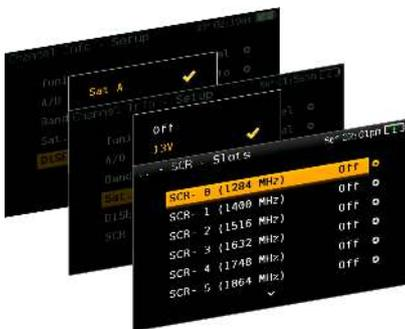
Mit dem H30FLEX können alle wichtigen Parameter gemessen und eingestellt werden, die für den Empfang eines Satellitensignals nötig sind. Mit der SCR-Funktion (Option 593534) können auch moderne Einkabelanlagen mit dCSS-Technologie eingemessen werden.
