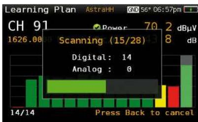
Mit der ultra-schnellen Funktion „Messplan“ kann sofort geprüft werden, welche Kanäle im Verteilnetz vorhanden sind. Danach kann ein benutzerdefinierter Kanalplan erstellt werden, der nur jene Kanäle enthält, die von Interesse sind. Zudem wird jeder Kanal in einem Balkendiagramm in der Farbe angezeigt, der ihm gemäß ausgewähltem Qualitätsprofil entspricht.
