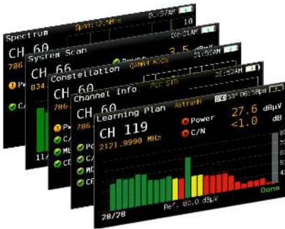
Eine umfassende Auswahl an Funktionen wie z.B. Kanalmessungen, Konstellations-Diagramme, Spektrumanalyzer, Service-Identifikation, Daten-Logs, Auto-Learning-Funktion von Kanalplänen, etc. steht zur Verfügung.
