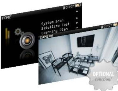
Die Installationen von Videoüberwachungssystemen steigen stetig an. Zur Anzeige und Überwachung von analogen Überwachungskameras bieten wir für die H30FLEX-Messgeräte eine neue Software-Option und einen USB-Video-Capture-Konverter mit Audio-, Video- und CVBS-Eingangsbuchsen. Auf dem H30FLEX können die Videoformate NTSC und PAL angezeigt werden. Mit diesem System besteht die Möglichkeit, die korrekte Funktion der Kameras zu überprüfen.
