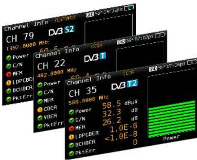
Das H30FLEX erfüllt die besonderen Anforderungen der Antennenmesstechnik für ein zukunftsfähiges TV-Verteilnetz. Es ist ein Multi-Standard-Messgerät, das Satelliten-Messungen durchführen kann, aber auch, je nach Konfiguration Terrestrische-Signale messen kann. Da sich Bedürfnisse und Anforderungen an ein Messgerät zukünftig ändern können, bietet das H30Flex jederzeit die Möglichkeit zusätzliche Optionen hinzuzufügen, ohne dass das Messgerät eingeschickt werden muss.
