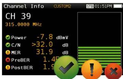
Réduire les erreurs d'installation avec les indicateurs qualitatifs à l'écran, une forme graphique qui facilite et rationalise l'interprétation des résultats de mesure. Il existe différents seuils suivant la partie du réseau à analyser: Station, amplificateurs, dérivation, raccordement, prise utilisateur, etc. En plus des valeurs préconfigurées, il est possible de personnaliser ses propres valeurs de seuil.
