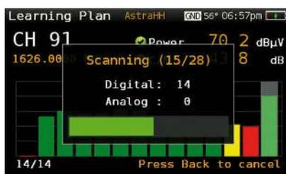
Découvrez les canaux présents dans la distribution avec la fonction ultra rapide Capture de Plan et créez à partir de là un plan de canaux utilisateur qui ne contient que les canaux que vous avez choisis. En outre, chaque canal apparaît dans un diagramme de barres, avec la couleur adaptée au seuil de qualité sélectionné.
