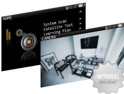
Les installations de systèmes de vidéosurveillance sont de plus en plus nombreuses. Les mesureurs H30FLEX permettent désormais d'afficher et de gérer les caméras de vidéosurveillance analogiques, grâce à leur nouvelle option logicielle et au convertisseur vidéo USB, avec connecteurs d'entrée Audio, Vidéo et CVBS. Le H30FLEX traite les formats vidéo NTSC et PAL. La meilleure option pour vérifier le bon fonctionnement du système.
