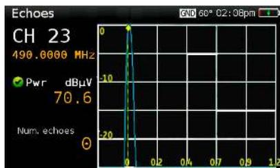
Lors de la réception de signaux terrestres, un des très importants paramètres à contrôler, est la présence d'échos pouvant dégrader les signaux à distribuer. Le H30FLEX permet de visualiser ces echos, permettant à l'installateur de minimiser le plus possible ce phénomène pour obtenir une réception optimisée du signal.
