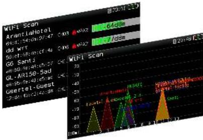
Diese Funktionalität ermöglicht eine vollständige Analyse des Wi-Fi-Bandes zur automatischen Erkennung aller Netzwerke. Alle werden jeweils durch den Namen identifiziert, und die Stärke des Signals am Zugangspunkt wird ebenfalls angezeigt. Es stehen zwei Anzeigemodi zur Auswahl. Der Modus "Liste" stellt eine Liste der erkannten Netzwerke mit den zugehörigen Daten und Leistungen zur Verfügung, während der Modus "Karte" diese auf einer zweiachsigen Karte darstellt: Leistung vs. Frequenz.
