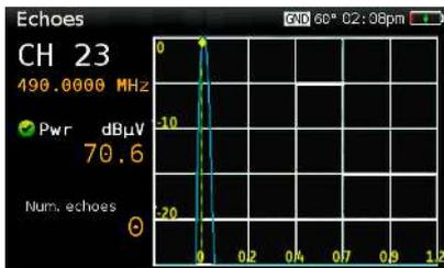
Bei der Erfassung von terrestrischen Signalen ist es von größter Wichtigkeit, darauf zu achten, dass es keine Echos gibt, die Probleme beim Empfang der Signale verursachen können. Das H30Evolution ermöglicht die Visualisierung der Echos des empfangenen Signals, was es dem Installateur erlaubt, diese Echos bestmöglich zu minimieren, um einen optimalen Signalempfang zu erreichen.
