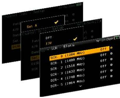
Mit dem H30Evolution können alle wichtigen Parameter gemessen und eingestellt werden, die für den Empfang eines Satellitensignals nötig sind. Mit der SCR-Funktion (Option 593534) können auch moderne Einkabelanlagen mit dCSS-Technologie eingemessen werden.
