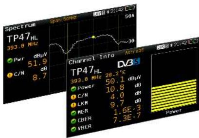
Diese Funktionalität für DVB-S/S2 ermöglicht die vollständige Analyse eines Satellitenkanals auf jeder Frequenz im Bereich von 250 MHz bis 2300 MHz.
