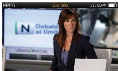
Mit der MPEG-Funktion des H30Evolution kann angezeigt werden welche Inhalte sich auf einem digitalen Kanal befinden? Zusätzlich zu den Videodarstellungen können auch weitere wichtige Parameter abgerufen werden: Name des Services, PID, die Auflösung, die verfügbaren Tonspuren sowie die NIT-Informationen.
