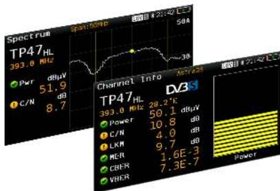
Esta funcionalidad para DVB-S/S2, permite analizar al completo un canal satélite en cualquier frecuencia de una amplia banda, comprendida entre 250 - 2300MHz. Así, es posible conectar el medidor directamente a cualquier salida de un LNB Wideband (2 salidas: Vertical y Horizontal)
