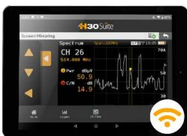
Utrustat med trådlös anslutning via en Android- eller iOS-enhet eller en PC. Webbapplikationen H30Suite (ref. 100016) kan användas för att kontrollera och exportera lagrade mätningar, tillgång till kvalitetsprofiler, kloning av instrumentinställningar, instrumentregistrering, via ett användarvänligt gränssnitt eller konsultation av användarmanualen i realtid.
