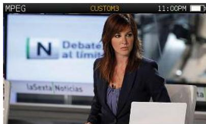
Vill du se det DIGTALA programmet som visas? H30Evolution med sin MPEG-funktion löser detta åt dig. Förutom att kunna se programmet, får du också information om nyckelparametrar som: Service namn, PID, upplösning, audio typ/värde, samt NIT. Detta ger dig ovärderlig hjälp vid felsökning i encoder-konfigurationen.
