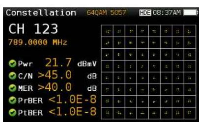
Konstellationsanalysen är ett grundläggande sätt för att bestämma kvaliteten på digitala signaler. Det bidrar till att lokalisera brus, jitter, störningar och signalmättnad, kort sagt alla de variabler som kan påverka bildkvaliteten negativt eller rent utav skapa bildbortfall. Genom att visuellt inspektera storlek och form i konstellationsmatrisen, kan man som tekniker enkelt identifiera bakgrunden till problemen.
