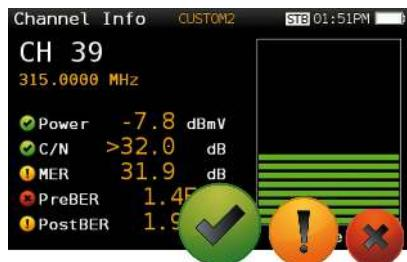
Det är enkelt att minimera installations-misstag med instrumentets Pass/Fail indikator, ett grafiskt verktyg för att snabbt skapa förståelse för mätresultatet. Flera olika nivåer finns att välja på för att definiera var "godkänt-värde" ska ligga, helt beroende på vad som ska mäts: huvudcentral, bredbandsförstärkare, nätverk, överlämningspunkter, lägenhet/villa, etc. Förutom ett antal fördefinerade värden, går det också att själv bestämma önskade värden för när signalen ska få status "godkänd".
