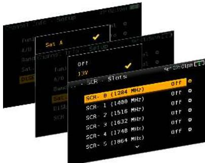
H30Evolution ger dig möjlighet att konfigurera precis de parametrar du behöver för mottagning och mätning av satellitsignalerna. För detta, ger H30Evolution dig tillgång till spänningsmatning och konfiguration av både DiSEqC och SCR parametrar.
