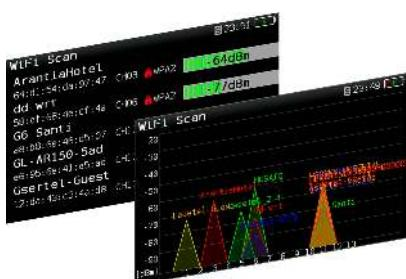
Denna funktionalitet tillåter en fullständig analys av WiFi-bandet med automatisk upptäckt av alla nätverk. Var och en av dem identifieras med namn, och effektnivån från accesspunkten visas. Två visningslägen tillhandahålls för användaren. "List-läget" ger en lista över detekterade nätverk med tillhörande data och effektnivå, medan "Kart-läget" visar dem på en tvåaxlad karta: effektnivå kontra frekvens.
