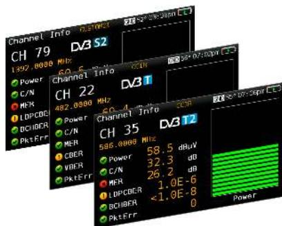
H30Evolution är förberett för varje användares speciella behov. Det är ett multi-standardinstrument, klart för mätningar inom satellitbandet, och det terresta bandet. För att möta användarens förändrade mätbehov, går det enkelt att ladda ned nya mätfunktioner och uppdateringar, normalt utan att behöva returnera instrumentet till fabriken.
