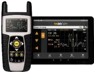
Med H30Evolution multiskärm-system kan du visa instrumentets skärm på din smartphone eller surfplatta för att trådlöst styra utrustningen eller bara för att arbeta med en större skärm. Installatören kan trådlöst komma åt utrustningen när som helst, var som helst i installationen (beroende på den lokala nätverksanslutningen), med bekvämligheten att alltid använda sin egen enhet.
