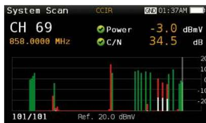
Med H30Evolution är scanning i realtid enkelt, både av analoga och digitala kanaler. Detta gör det möjligt att i realtid bestämma den totala frekvensgången. Denna funktion ger verkligen en möjlighet att säkerställa signalparametrarna och påvisa att dessa uppfyller kabel-tv-nätets uppställda specifikationer genom en överskådlig grön, gul eller röd indikering. Det räcker med en snabb blick för att konstatera status på systemet, inkluderande BER- och MER-värden på den valda kanalen.
