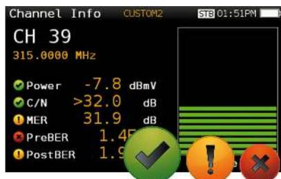
Reduzca los errores de instalación con los indicadores de pantalla Pasa/Falla, una forma gráfica que facilita y agiliza la interpretación de los resultados de medida. Se dispone de diferentes umbrales según la parte de la red a analizar: cabecera, central amplificadora, derivación, registros de conexión, vivienda de usuario, etc. Además de los valores preestablecidos, también podrá personalizar sus propios valores de umbral.
