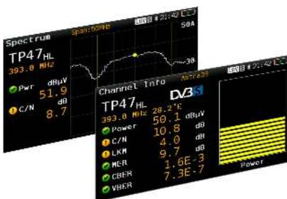
Esta funcionalidad para DVB-S/S2, permite analizar al completo un canal satélite en cualquier frecuencia de una amplia banda, comprendida entre 250 - 2300MHz. Así, es posible conectar el medidor directamente a cualquier salida de un LNB Wideband (2 salidas: Vertical y Horizontal)
