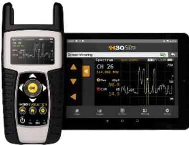
El sistema multipantalla de H30Evolution permite replicar la pantalla del medidor en su smartphone o tablet, para controlar el equipo a distancia o simplemente para disfrutar de una pantalla más grande. El instalador puede acceder siempre al medidor desde diferentes partes de la instalación, sin cables, y con toda la comodidad de utilizar su propio dispositivo.
