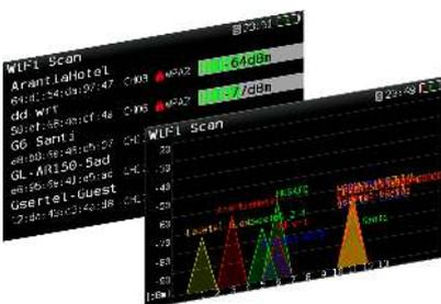
Con esta funcionalidad es posible realizar el análisis completo de la banda Wi-Fi para detectar automáticamente todas las redes. Cada una de ellas es identificada con su nombre y además se presenta la potencia de la señal del punto de acceso. Se ofrecen dos modos de visualización, a elección del usuario. El modo "lista" ofrece un listado de las redes detectadas con sus datos y potencia, mientras que el modo "mapa" las sitúa en un mapa de ejes: potencia vs frecuencia.
