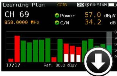
El medidor detecta de manera automática si existe una nueva versión de software cuando se conecta a internet (WiFi, Ethernet). Para avisar de que hay un nuevo software disponible, se activa un icono en la parte superior derecha, sin interrumpir el trabajo que el usuario pueda estar realizando. Se accede a la actualización del equipo a través del menú de configuración.
