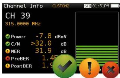
Reduzca los errores de instalación con los indicadores de pantalla Pasa/Falla, una forma gráfica que facilita y agiliza la interpretación de los resultados de medida. Se dispone de diferentes umbrales según la parte de la red a analizar: cabecera, central amplificadora, derivación, registros de conexión, vivienda de usuario, etc. Además de los valores preestablecidos, también podrá personalizar sus propios valores de umbral.
