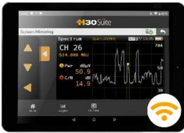
Equipado con una conectividad inalámbrica, el equipo permite el acceso seguro a través de un dispositivo Android, iOS o PC (navegador). De esta forma, es posible utilizar a distancia la aplicación de gestión WEB H30Suite (ref. 100016) en la que se puede consultar y exportar la información almacenada en el medidor, acceder a los perfiles de calidad, clonar la configuración del equipo, registrar el medidor o consultar el manual de usuario en tiempo real.
