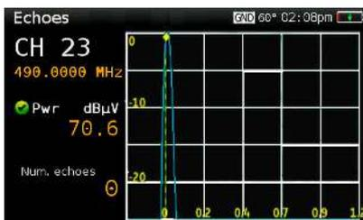
En la captación de señales terrestres es importantísimo controlar que no haya ecos que puedan ocasionar problemas en la recepción de las mismas. El H30Crystal permite visualizar los ecos de la señal recibida, permitiendo al instalador minimizar en lo posible los mismos para obtener una recepción óptima de la señal.
