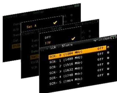
L'H30Crystal è configurato per impostare automaticamente i parametri necessari ed eggianciare il suo segnale satellitare. Inoltre con l'H30Crystal potremo alimentare amplificatori da palo, configurare parametri DiSEqC e SCR/dCSS.
