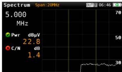
La capacità dello strumento di misurare il canale di ritorno da 5 MHz è molto utile per i tecnici che seguono impianti con distribuzione via cavo. E' possibile Visualizzare il segnale nello spettro, misurare potenza e C/N, oltre che poter garantire la qualità dei dati di upload trasmessi su questa gamma di frequenza.
