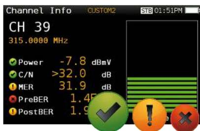
Si riducono gli errori nell' installazione con gli indicatori SUPERATO/FALLITO, con una rappresentazione grafica che facilita e rende intuitiva l'interpretazione delle misure. Si dispone di differenti soglie in funzione della posizione di misura lungo la distribuzione: centrale di testa, amplificatori, distribuzione, prese, etc. Oltre ai valori di default, potrà personalizzare le sue soglie.
