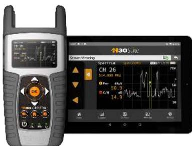
Il sistema multischermo dell'H30Crystal consente di replicare lo schermo del misuratore sul tuo smartphone o tablet, per controllare lo strumento a distanza o semplicemente per usufruire di uno schermo più grande. Controllabile da dispositivi mobili (Android e iOS) e PC (Windows e iOS con browser compatibile con HTML5). L'installatore può accedere sempre al misuratore da differenti parti dell'installazione, senza cavi, e con tutta la comodità di utilizzare il proprio dispositivo.
