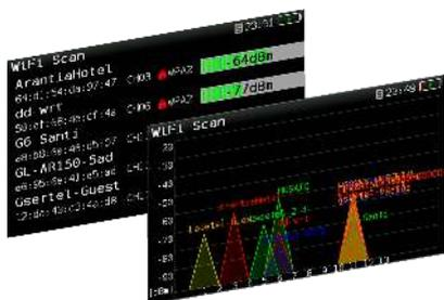
Con questa funzione è possibile realizzare l'analisi completa della banda WiFi per determinare automaticamente tutte le reti. Ognuna di esse è identificata con il proprio nome ed inoltre viene mostrata anche la potenza del segnale del access point. Sono possibili due modi di visualizzazione, a scelta dell'utente. Il modo "elenco" offre la lista delle reti rilevate con i loro dati e la potenza, mentre il modo "mappa" realizza un grafico ad assi: potenza vs frequenza.
