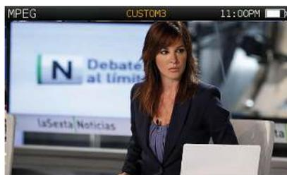
Vuole sapere quali contenuti vengono offerti in un canale DIGITALE? La funzione MPEG dell'H30Crystal ve lo dirà. Oltre a mostrare le immagini dei servizi del canale, mostrerà anche parametri importanti riferiti agli stessi: Nome del servizio, PID, risoluzione, tipo e numero di audio e NIT. Un grande aiuto per risolvere problemi relativi alla configurazione della codifica.
