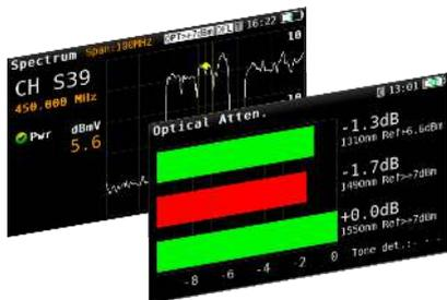
El equipo integra un receptor óptico (con opción de selectivo o no selectivo) que permite medir con precisión la potencia y atenuación en las longitudes de onda 1310nm, 1490nm y 1550nm. El empleo de la variante selectiva en conjunto con el generador de luz triple (OPS3L), resulta una elección adecuada para certificar la infraestructura óptica de la ICT-2.
