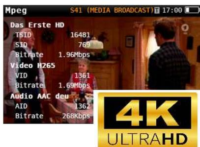
Esta funcionalidad soporta el formato de compresión HEVC H.265 y permite visualizar señales de vídeo con una resolución máxima 4K - UHD (3840 x 2160). La visualización puede ser en la pantalla del medidor, y también en la del dispositivo móvil (modo multipantalla) si su hardware es compatible H.265 (normalmente un smartphone, tablet o PC).
