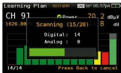
Hitta och identifiera kanalerna i ditt eget distributionsnät med den snabba "Capture Plan"-funktionen, och från där, bygg upp din egen mätplan i instrumentet med endast de kanaler du är mest intresserade av. Dessutom kommer du att se varje vald kanal i displayen med en "godkännandefärg", grönt, gult eller rött helt efter dina egna inprogrammerade kvalitetskrav.
