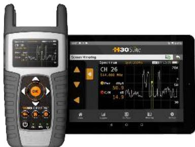
Med H30Crystal multiskärm-system kan du visa instrumentets skärm på din smartphone eller surfplatta för att trådlöst styra utrustningen eller bara för att arbeta med en större skärm.
