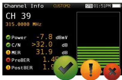
Det är enkelt att minimera installations-misstag med instrumentets Pass/Fail indikator, ett grafiskt verktyg för att snabbt skapa förståelse för mätresultatet. Flera olika nivåer finns att välja på för att definiera var "godkänt-värde" ska ligga, helt beroende på vad som ska mätas: huvudcentral, bredbandsförstärkare, nätverk, överlämningspunkter, lägenhet/villa, etc. Förutom ett antal fördefinerade värden, går det också att själv bestämma önskade värden för när signalen ska få status "godkänd".
