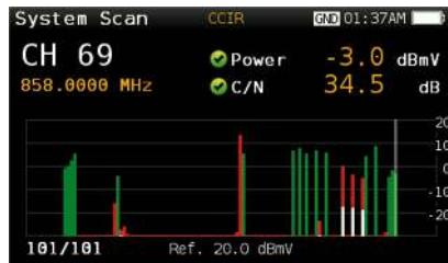
Med H30Crystal är scanning i realtid enkelt, både av analoga och digitala kanaler. Detta gör det möjligt att i realtid bestämma den totala frekvensgången. Denna funktion ger verkligen en möjlighet att säkerställa signalparametrarna och påvisa att dessa uppfyller kabel-tv-nätets uppställda specifikationer genom en överskådlig grön, gul eller röd indikering. Det räcker med en snabb blick för att konstatera status på systemet, inkluderande BER- och MER-värden på den valda kanalen.
