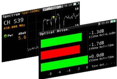
Denna enhet är utrustad med en optisk mottagare (selektiva eller icke-selektiva referenser), som gör det möjligt att mäta effekt och dämpning vid våglängder på 1310 nm, 1490 nm och 1550 nm. Att kombinera den selektiva referensen med trippelljusgeneratorn (OPS3L), ger rätt val för att certifiera optiska IKT-2 infrastrukturer. Optisk anslutning är via SC/APC-kontakt och utrustningen levereras med ett kit inklusive optiska tillbehör, som gör den mer flexibel vid andra typer av optisk anslutning.
