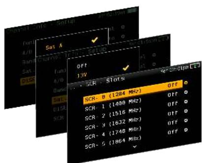
H30Crystal ger dig möjlighet att konfigurera precis de parametrar du behöver för mottagning och mätning av satellitsignalerna. För detta, ger H30Crystal dig tillgång till spänningsmatning och konfiguration av både DiSEqC och SCR parametrar.
