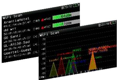
Denna funktionalitet tillåter en fullständig analys av WiFi-bandet med automatisk upptäckt av alla nätverk. Var och en av dem identifieras med namn, och effektnivå från accesspunkten visas. Två visningslägen tillhandahålls för användaren. "List-läget" ger en lista över detekterade nätverk med tillhörande data och effektnivå, medan "Kart-läget" visar dem på en tvåaxlad karta: effektnivå kontra frekvens.
