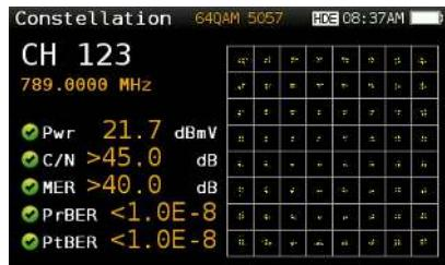
Konstellationsanalysen är ett grundläggande sätt för att bestämma kvalitén på digitala signaler. Det bidrar till att lokalisera brus, jitter, störningar och signalmättnad, kort sagt alla de variabler som kan påverka bildkvaliteten negativt eller rent utav skapa bildbortfall. Genom att visuellt inspektera storlek och form i konstellationsmatrisen, kan man som tekniker enkelt identifiera bakgrunden till problemen.
