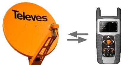
Denna funktion påskyndar injustering av parabolen. Instrumentet väljer en typisk satellittransponder i enlighet med den valda zonen och ger självkonfigurerad LNB-inställning. Dessutom kan en ljudindikator aktiveras för att via en ljudsignal leda användaren i att justera parabolanten.
