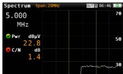
Instrumentets kapacitet att mäta returkanalen från 5 MHz är väldigt användbar för tekniker vid inmätning av kabel-tv-installationer. Genom att visa spektrumet, nivå och C/N är det möjligt att säkerställa en god status och kvalitet för data, som överförs på denna bandbredd.
