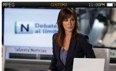
Vill du se det DIGTALA programmet som visas? H30Crystal med sin MPEG-funktion löser detta åt dig. Förutom att kunna se programmet, får du också information om nyckelparametrar som: Service namn, PID, upplösning, audio typ/värde, samt NIT. Detta ger dig ovärderlig hjälp vid felsökning i encoder-konfigurationen.
