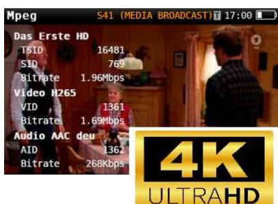
Den här funktionen stöder det komprimeringsformatet HEVC H.265 och gör det möjligt att visa videosignaler med maximal 4K/UHD-upplösning (3840 x 2160). Information kan visas både på instrumentskärmen eller på den mobila enheten (flerskärmssläge) så länge hårdvaran är H.265-kompatibel (vanligtvis en smartmobil, surfplatta eller dator).
