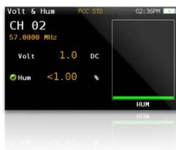
¿Preocuparse de tener que llevar además un voltímetro con usted...? No hay problema, el H30+ también hará esto por usted. El H30+ le dará un porcentaje Hum para ayudar a diagnosticar problemas de interferencias de tierra y energía que puedan derivar de una fuente de alimentación defectuosa o de un inyector sobrecargado.
