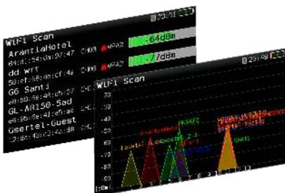
Con esta funcionalidad es posible realizar el análisis completo de la banda Wi-Fi para detectar automáticamente todas las redes. Cada una de ellas es identificada con su nombre y además se presenta la potencia de la señal del punto de acceso. Se ofrecen dos modos de visualización, a elección del usuario. El modo “lista” ofrece un listado de las redes detectadas con sus datos y potencia, mientras que el modo “mapa” las sitúa en un mapa de ejes: potencia vs frecuencia.
