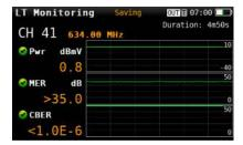
La fonction Long Term Monitoring du H30+ permet de surveiller automatiquement un canal sélectionné. Une fois que l'intervalle de temps entre deux mesures consécutives a été sélectionnée, le H30+ prend automatiquement toutes les mesures sur le canal sélectionné et les enregistre en mémoire.
