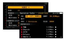
Vous voulez savoir quel contenu est proposé sur un canal QAM? La fonction Service Info du H30+ vous le dira. En plus d'une brève description du service, vous obtiendrez des paramètres importants tels que la NIT, la PAT et le TSID du canal, le SID et le PID de chaque service, le type d'encodage, la résolution et le débit binaire pour l'audio et la vidéo. Une aide précieuse pour le dépannage des problèmes liés à la configuration de l'encodage.
