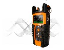
Ce produit a été conçu dès l'origine pour obtenir de façon instantanée toute l'information du signal en temps réel, une étape importante pour le travail de terrain. Le H30+ fournit la précision et la vitesse nécessaire à la détection d' impulsions transitoires, de radiations, ou de signaux parasites qui peuvent affecter le système, à la réception du signal.
