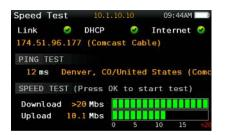
Vous avez besoin d'une vérification rapide de votre réseau de données au niveau de la tête de réseau ou du terminal client? Le test de vitesse IP H30+ vous permet de vérifier les paramètres de performance de votre réseau sans avoir à sortir votre ordinateur portable. Cela comprend les débits de téléchargement montants et descendants ainsi que les temps de ping et les statistiques de perte de paquets.
