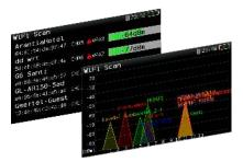
Cette fonctionnalité permet d'effectuer l'analyse complète de la bande Wi-Fi pour détecter automatiquement tous les réseaux. Chacun d'entre eux est identifié par son nom et sa puissance. Deux modes d'affichage sont proposés, au choix de l'utilisateur. Le mode "liste" offre une liste des réseaux détectés avec leurs données et leur puissance, tandis que le mode "carte" les place sur une carte à 2 axes: puissance vs fréquence.
