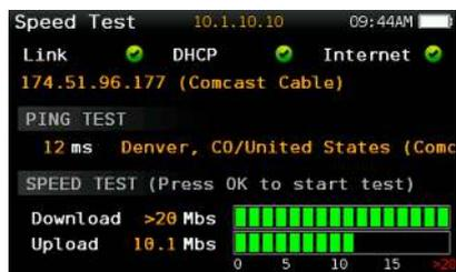
Hai bisogno di un rapido controllo della tua rete dati presso la centrale o presso l'unità di un cliente? Il test di velocità IP dell'H30+ ti consente di controllare i parametri di base delle prestazioni di rete, quindi non è necessario usare il laptop. Questo include la velocità di upload e download, nonché i tempi di ping e le statistiche sui pacchetti persi.
