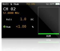
Non vuoi preoccuparti di portare con te un voltmetro a parte...? Nessun problema, anche l'H30+ lo farà. L'H30+ ti darà anche una percentuale di ronzio per aiutarti a diagnosticare quei problemi di interferenza di terra e di alimentazione che possono derivare da un alimentatore difettoso o da inseritori di alimentazione difettosi / sovraccarichi.
