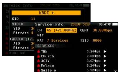
Vuoi sapere qual è il contenuto del programma su quel canale QAM? La funzione Info servizio dell'H30+ te lo dirà. Oltre alla breve descrizione del servizio, otterrai i parametri importanti tra cui NIT, PAT e TSID per il canale e per il singolo servizio otterrai SID e PID, tipo di codifica, risoluzione e bitrate per l'audio e per il video, tutti elementi di grande aiuto per la risoluzione dei problemi di configurazione del codificatore.
