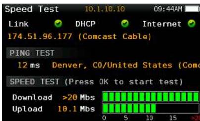
Müssen Sie ein Datennetz an der Kopfstation oder am Kundengerät schnell prüfen? Mit dem IP Geschwindigkeitstest des H30D+ können dessen Betriebsgrundparameter des Netzwerks geprüft werden, ohne den Laptop öffnen zu müssen. Dazu gehören die Up- und Downloadgeschwindigkeit wie auch die "Ping"-Zeiten und Statistiken der verlorenen Pakete.
