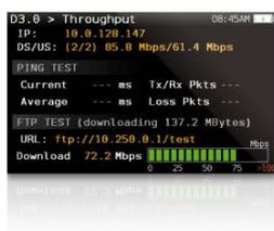
Mit dieser Funktion werden die Up- und Downloadgeschwindigkeiten des DOCSIS-Netzwerkes gemessen. Die Messungen erfolgen unter der Verwendung eines FTP-Servers, der vom Anwender konfiguriert werden muss (URL, Datei, get/put, Anwender und Passwort). Diese Funktion zeigt die Modem-IP-Adresse im DOCSIS Netzwerk wie auch die verhandelten Höchst- und Mindestgeschwindigkeiten (DS/US). Sobald der Geschwindigkeitstest beginnt, wird die Geschwindigkeit ständig aktualisiert.
