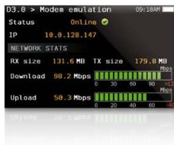
Diese Funktion konfiguriert das H30D+ für den Einsatz als DOCSIS Modem und um einem anderen Gerät Anschluss an das DOCSIS Netzwerk mit dem Ethernet-Port des H30D+ zu bieten. Diese Funktion zeigt den Status des Modemanschlusses wie auch die momentane Geschwindigkeit und die über das Modem gesendete Datengröße.
