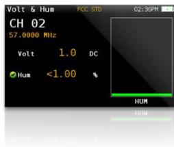
Sie möchten nicht auch noch ein Voltmessgerät mitnehmen müssen? ... Kein Problem, das H30D+ übernimmt das auch für Sie! Das H30D+ gibt Ihnen einen Prozentsatz für das Brummen, mit dem Sie Probleme aufgrund von Erdungs- oder Stromstörungen feststellen können, die sich aus einem beschädigten Netzschalter oder einem überlasteten Injektor ableiten können.
