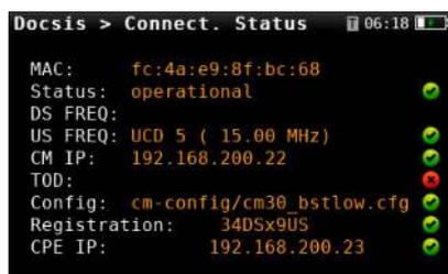
Ottenere un'indicazione passo passo di un test di superamento/fallimento, che il modem trova, si connette e si registra a una centrale (CMTS) per ottenere anche i parametri critici nel processo. Verificare che il modem trovi prima il canale downstream e, subito dopo, il canale upstream. Successivamente ottenere la configurazione come server dell'indirizzo DHCP, ora del server TOD, il file di configurazione completo e le informazioni di registrazione.
