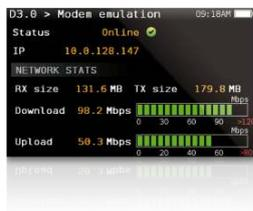
Questa funzione imposta l'H30D+ per essere utilizzato come modem DOCSIS e utilizzarlo per fornire ad un altro dispositivo una connessione alla rete DOCSIS tramite la porta ethernet dell'H30D+. Questa funzione mostra lo stato della connessione del modem, nonché la velocità istantanea e la dimensione dei dati inviati tramite il modem.
