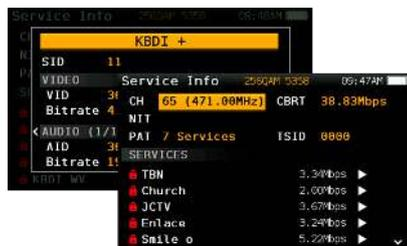
Vuoi sapere qual è il contenuto del programma su quel canale QAM? La funzione Info servizio dell'H30D+ te lo dirà. Oltre alla breve descrizione del servizio, otterrai i parametri importanti tra cui NIT, PAT e TSID per il canale e per il singolo servizio otterrai SID e PID, tipo di codifica, risoluzione e bitrate per l'audio e per il video, tutti elementi di grande aiuto per la risoluzione dei problemi di configurazione del codificatore.
