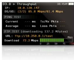
Questa funzione misura le velocità upstream and downstream e della rete DOCSIS. Le misurazioni della velocità vengono eseguite utilizzando un server FTP che deve essere configurato dall'utente (URL, file, get/put, utente, password). Questa funzione mostra il modem IP all'interno della rete DOCSIS e la velocità massima negoziata (DS/US). Quando si avvia il test di velocità, il valore della velocità viene costantemente aggiornato.
