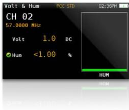
Non vuoi preoccuparti di portare con te un voltmetro a parte...? Nessun problema, anche l'H30D+ lo farà. L'H30D+ ti darà anche una percentuale di ronzio per aiutarti a diagnosticare quei problemi di interferenza di terra e di alimentazione che possono derivare da un alimentatore difettoso o da inseritori di alimentazione difettosi / sovraccarichi.
