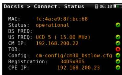
Erfassen Sie Schritt für Schritt einen Pass/Fail-Test, indem das Modem eine Kopfstelle (CMTS) findet, sich mit dieser verbindet und sich dort registriert und dabei auch kritische Parameter ermittelt. Bestätigen Sie, dass das Modem zuerst den Downstream-Kanal und gleich danach den Upstream-Kanal findet. Beziehen Sie später die Konfiguration als DHCP-Adress-Server, TOD-Server-Zeit, die komplette Konfigurationsdatei und die Registrierungsinformationen.
