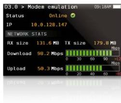
Diese Funktion konfiguriert das H30D+ für den Einsatz als DOCSIS Modem und um einem anderen Gerät Anschluss an das DOCSIS Netzwerk mit dem Ethernet-Port des H30D+ zu bieten. Diese Funktion zeigt den Status des Modemanschlusses wie auch die momentane Geschwindigkeit und die über das Modem gesendete Datengröße.
