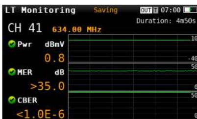
Die Langzeitüberwachungsfunktion des H30D+ ermöglicht die automatische Überwachung des gewählten Kanals. Sobald das Zeitintervall zwischen zwei aufeinanderfolgenden Messungen gewählt wurde, nimmt das H30D+ automatisch alle Messungen des gewählten Kanals auf und speichert sie.
