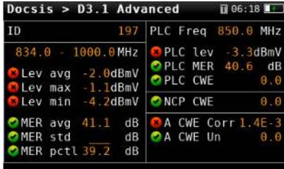
Diese Funktion zeigt alle Messungen für den DOCSIS-OFDM-Kanal an. Zusätzlich zu den MER- und Pegelmessungen werden auch alle PLC- und NCP-Messungen angezeigt.
