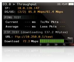
Mit dieser Funktion werden die Up- und Downloadgeschwindigkeiten des DOCSIS-Netzwerkes gemessen. Die Messungen erfolgen unter der Verwendung eines FTP-Servers, der vom Anwender konfiguriert werden muss (URL, Datei, get/put, Anwender und Passwort). Diese Funktion zeigt die Modem-IP-Adresse im DOCSIS Netzwerk wie auch die verhandelten Höchst- und Mindestgeschwindigkeiten (DS/US). Sobald der Geschwindigkeitstest beginnt, wird die Geschwindigkeit ständig aktualisiert.
