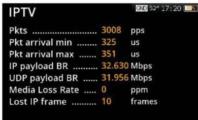
Es ermöglicht die Demodulation und Analyse von IPTV-Streams (sowohl Unicast als auch Multicast), nicht nur durch Videoanzeige, sondern auch durch Anzeige der Gesamtbirrate und Birrate für jeden vorhandenen Service. Die relevanten Informationen für jeden Service sind ebenfalls bereits enthalten: SID, VPID, AID, Videoprofil, Birrate für Audio und Video.
