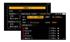
Möchten Sie wissen, welche Inhalte in einem QAM Kanal angeboten werden? Die Service-Info-Funktion des H30D+ zeigt es Ihnen. Neben einer kurzen Servicebeschreibung erhalten Sie wichtige Parameter wie NIT, PAT und TSID des Kanals, SID und PID der einzelnen Services, Kodierungsart, Lösung und Bid Rate für Audio und Video. Eine große Unterstützung bei der Problemlösung in Verbindung mit der Kodierungskonfigurierung.
