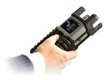
Ein exklusives Gummigehäuse aus Doppelspritzguss und Kunststoffpolykarbonat garantieren Schutz und Lebensdauer. Das H30+ wiegt nur etwa 500 Gramm, so dass es bequem transportiert und eingesetzt werden kann. Sie können es in der Tasche tragen oder auch den Tragegurt nutzen, um es über die Schulter zu hängen... Sie werden es kaum bemerken...!
