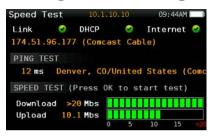
Müssen Sie ein Datennetz an der Kopfstation oder am Kundengerät schnell prüfen? Mit dem IP Geschwindigkeitstest des H30D+ können dessen Betriebsgrundparameter des Netzwerks geprüft werden, ohne den Laptop öffnen zu müssen. Dazu gehören die Up- und Downloadgeschwindigkeit wie auch die "Ping"-Zeiten und Statistiken der verlorenen Pakete.
