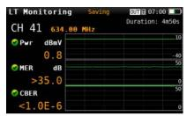
Die Langzeitüberwachungsfunktion des H30D+ ermöglicht die automatische Überwachung des gewählten Kanals. Sobald das Zeitintervall zwischen zwei aufeinanderfolgenden Messungen gewählt wurde, nimmt das H30D+ automatisch alle Messungen des gewählten Kanals auf und speichert sie.
