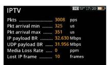
Es ermöglicht die Demodulation und Analyse von IPTV-Streams (sowohl Unicast als auch Multicast), nicht nur durch Videoanzeige, sondern auch durch Anzeige der Gesamtbitrate und Bitrate für jeden vorhandenen Service. Die relevanten Informationen für jeden Service sind ebenfalls bereits enthalten: SID, VPID, AID, Videoprofil, Bitrate für Audio und Video.
