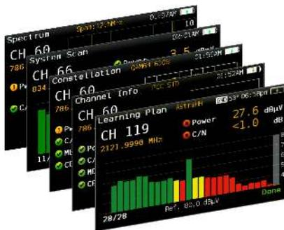
Un completo repertorio de funcionalidades como Medidas de un sólo Canal, System Scans, Diagrama de Constelación, Analizador de Espectro, Datalogs, Auto-Learning de plan de Canales, y más.
