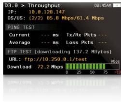
Esta función mide las velocidades de subida y baja de la red DOCSIS. Las medidas se realizan utilizando un servidor FTP que debe ser configurado por el usuario (URL, fichero, get/put, usuario y password). Esta función muestra la IP del modem en la red DOCSIS y la velocidad máxima y mínima negociadas (DS/US). Una vez que comienza el test de velocidad, esta se actualiza constantemente
