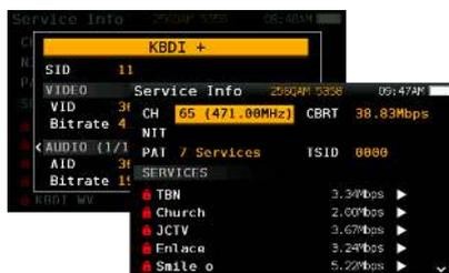
¿Quiere saber qué contenidos se ofrecen en un canal QAM? La función Info de Servicio del H30D+ se lo dirá. Además de una corta descripción del servicio, obtendrá parámetros importantes como el NIT, PAT y el TSID de canal, el SID y el PID de cada servicio, el tipo de codificación, la resolución y el bit rate para audio y vídeo. Una gran ayuda para solucionar problemas relacionados con la configuración de la codificación.
