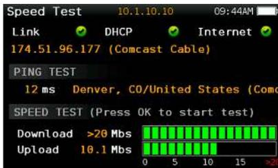
¿Necesita una verificación rápida de su red de datos en la cabecera o en la unidad del cliente? El test de velocidad IP del H30D+ le permite verificar sus parámetros básicos de funcionamiento de la red sin tener que sacar su PC portátil. Esto incluye la velocidad de upload y download así como los tiempos de “ping” y estadísticas de paquetes perdidos.
