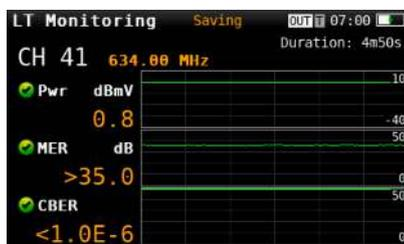
La función Long Term Monitoring del H30D+ permite hacer una monitorización automática del canal seleccionado. Una vez seleccionado el intervalo de tiempo que ha de transcurrir entre dos tomas de medidas consecutivas, el H30D+ realizará de manera automática todas las medidas en el canal seleccionado y las guardará en memoria.
