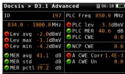
Esta función muestra todas las medidas del canal OFDM DOCSIS. Además de las mediciones de nivel y MER, también se muestran todas las mediciones del PLC y NCP.
