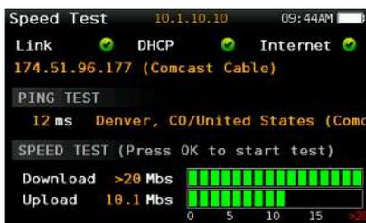
Vous avez besoin d'une vérification rapide de votre réseau de données au niveau de la tête de réseau ou du terminal client ? Le test de vitesse IP H30D+ vous permet de vérifier les paramètres de performance de votre réseau sans avoir à sortir votre ordinateur portable. Cela comprend les débits de téléchargement montants et descendants ainsi que les temps de ping et les statistiques de perte de paquets.
