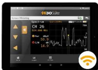
Doté d'une connectivité sans fil, l'appareil permet un accès sécurisé à un appareil Android, iOS ou PC (navigateur). Il est ainsi possible d'utiliser à distance l'application de gestion WEB H30Suite (réf. 100016), dans laquelle on peut consulter et exporter les informations stockées dans le mesureur, accéder aux profils qualité, cloner la configuration du mesureur, faire l'enregistrement du mesureur de champ, ou consulter en temps réel le manuel d'utilisation.
