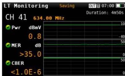
La fonction Long Term Monitoring du H30D+ permet de surveiller automatiquement un canal sélectionné. Une fois que l'intervalle de temps entre deux mesures consécutives a été sélectionnée, le H30D+ prend automatiquement toutes les mesures sur le canal sélectionné et les enregistre en mémoire.
