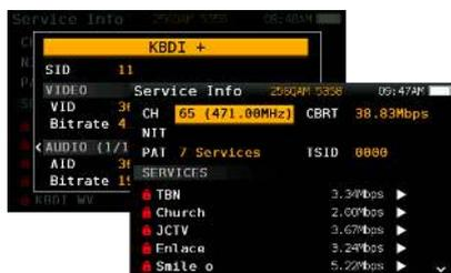
Vous voulez savoir quel contenu est proposé sur un canal QAM ? La fonction Service Info du H30D+ vous le dira. En plus d'une brève description du service, vous obtiendrez des paramètres importants tels que la NIT, la PAT et le TSID du canal, le SID et le PID de chaque service, le type d'encodage, la résolution et le débit binaire pour l'audio et la vidéo. Une aide précieuse pour le dépannage des problèmes liés à la configuration de l'encodage.
