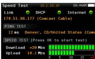
Hai bisogno di un rapido controllo della tua rete dati presso la centrale o presso l'unità di un cliente? Il test di velocità IP dell'H30D+ ti consente di controllare i parametri di base delle prestazioni di rete, quindi non è necessario usare il laptop. Questo include la velocità di upload e download, nonché i tempi di ping e le statistiche sui pacchetti persi.
