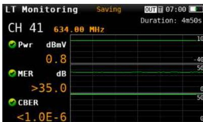
La funzione di monitoraggio a lungo termine dell'H30D+ consente il monitoraggio automatico del canale selezionato. Una volta selezionato l'intervallo di tempo tra due misurazioni consecutive, l'H30D+ prenderà automaticamente tutte le misure del canale selezionato e le memorizzerà.
