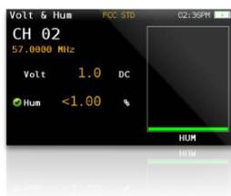
¿Preocuparse de tener que llevar además un voltímetro con usted...? No hay problema, el H30D+ también hará esto por usted. El H30D+ le dará un porcentaje Hum para ayudar a diagnosticar problemas de interferencias de tierra y energía que puedan derivar de una fuente de alimentación defectuosa o de un inyector sobrecargado.
