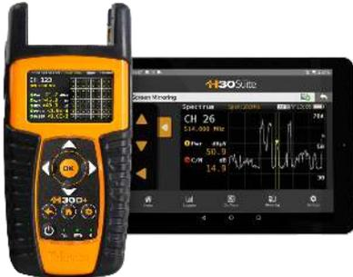
El sistema multipantalla de H30D+ permite replicar la pantalla del medidor en su smartphone o tablet, para controlar el equipo a distancia o simplemente para disfrutar de una pantalla más grande. El instalador puede acceder siempre al medidor desde diferentes partes de la instalación, sin cables, y con toda la comodidad de utilizar su propio dispositivo.
