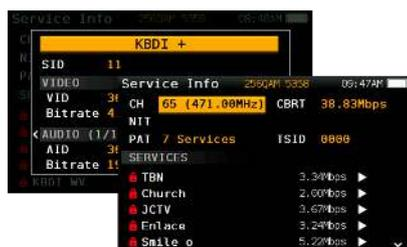
¿Quiere saber qué contenidos se ofrecen en un canal QAM? La función Info de Servicio de este H30D+ se lo dirá. Además de una corta descripción del servicio, obtendrá parámetros importantes como el NIT, PAT y el TSID de canal, el SID y el PID de cada servicio, el tipo de codificación, la resolución y el bit rate para audio y vídeo. Una gran ayuda para solucionar problemas relacionados con la configuración de la codificación.
