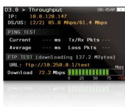
Esta función mide las velocidades de subida y baja de la red DOCSIS. Las medidas se realizan utilizando un servidor FTP que debe ser configurado por el usuario (URL, fichero, get/put, usuario y password). Esta función muestra la IP del modem en la red DOCSIS y la velocidad máxima y mínima negociadas (DS/US). Una vez que comienza el test de velocidad, esta se actualiza constantemente.
