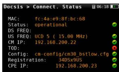
Obtenga una indicación paso a paso de un test pasa/falla, mientras el módem encuentra, se conecta, y se registra a una cabecera (CMTS) y obtiene los parámetros críticos en el proceso. Confirma que el modem primero encuentra un canal de bajada y posteriormente uno de subida. Obtenga posteriormente la configuración como la dirección del servidor DHCP, el tiempo del servidor TOD, el fichero completo de configuración y la información de registro.
