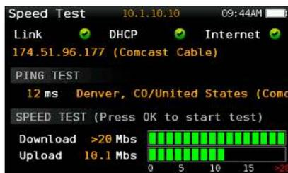
¿Necesita una verificación rápida de su red de datos en la cabecera o en la unidad del cliente? El test de velocidad IP del H30+ le permite verificar sus parámetros básicos de funcionamiento de la red sin tener que sacar su PC portátil. Esto incluye la velocidad de upload y download así como los tiempos de “ping” y estadísticas de paquetes perdidos.
