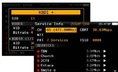
¿Quiere saber qué contenidos se ofrecen en un canal QAM? La función Info de Servicio del H30+ se lo dirá. Además de una corta descripción del servicio, obtendrá parámetros importantes como el NIT, PAT y el TSID de canal, el SID y el PID de cada servicio, el tipo de codificación, la resolución y el bit rate para audio y vídeo. Una gran ayuda para solucionar problemas relacionados con la configuración de la codificación.
