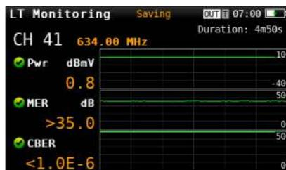
La función Long Term Monitoring del H30+ permite hacer una monitorización automática del canal seleccionado. Una vez seleccionado el intervalo de tiempo que ha de transcurrir entre dos tomas de medidas consecutivas, el H30+ realizará de manera automática todas las medidas en el canal seleccionado y las guardará en memoria.
