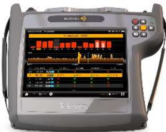
Réduire les erreurs d'installation avec les indicateurs qualitatifs à l'écran, une forme graphique qui facilite et rationalise l'interprétation des résultats de mesure. Il existe différents seuils suivant la partie du réseau à analyser: Station, amplificateurs, dérivation, raccordement, prise utilisateur, etc. En plus des valeurs préconfigurées, il est possible de personnaliser ses propres valeurs de seuil.
