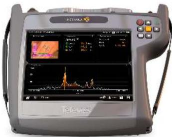
Fonction qui permet de visualiser et de mesurer les chaînes analogiques de télévision, encore utilisées dans des installations de télévision avec transmodulateurs. Permet de mesurer des niveaux entre 20 et 128 dBV, C/N jusqu'à 30 dB et V/A jusqu'à 52 dB.
