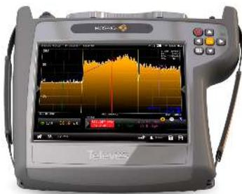
Analyseur de spectre professionnel avec traitement numérique ultra-rapide (Temps de balayage <math><10\text{ ms}</math>) et plage dynamique élevée (>50 dB). Il est doté de fonctions avancées pour la détection et l'analyse de signaux entre 5 et 3300 MHz (waterfall, alerte par évènements, marqueurs, RBW et VBW configurable par l'utilisateur, etc.)
