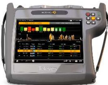
Raccordez le signal d'entrée à votre MOSAIQ6 et, en quelques secondes, le mesureur démodulera automatiquement le signal. Il recherche d'abord la norme, puis tous les paramètres.
