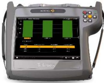
Une fois l'entrée fibre optique activée et grâce à son récepteur optique (sélectif ou non), le produit peut mesurer les affaiblissements optiques pour trois longueurs d'onde (1310nm, 1490nm et 1550nm), les puissances respectives, et analyser les installations RFOG.
