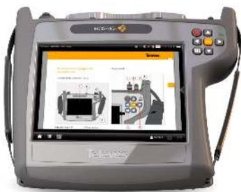
MOSAIQ6 inclut la fonction de consultation du manuel d'utilisation directement sur le mesureur. Cela permet de lever les doutes ou de suivre des instructions en temps réel, sans avoir besoin d'un document imprimé.
