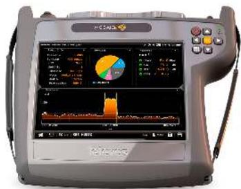
Fonction qui permet de démoduler un canal DAB, en faisant des mesures qualitatives telles que MER et CBER, ainsi que des informations complètes sur les services transmis: Radio info: (Ensemble, PTY, Service, Mode, Audio, débit audio). Permet de mesurer la puissance entre 20 et 128dB $\mu$ V, le C/N et le MER de ces signaux.
