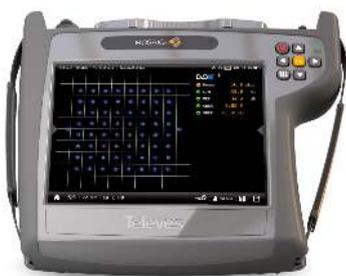
Das Konstellationsdiagramm ist unerlässlich, um das Vorhandensein von Rauschen, Phasenjitter, Interferenzen und anderen potenziellen Störungen zu erkennen, die die Signalqualität durch die Reduzierung der MER beeinträchtigen könnten.
