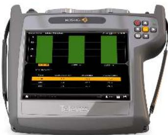
Sobald der Glasfasereingang aktiviert wurde kann dank des optischen Empfängers (selektiv oder nicht) die Messung der optischen Dämpfung für drei Wellenlängen (1310 nm, 1490 nm und 1550 nm) und deren Leistungen durchgeführt werden.
