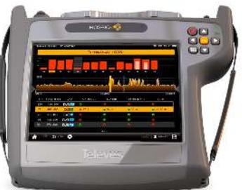
Installationsfehler einfach und unkompliziert mit der Ampeldarstellung erkennen. Hierbei handelt es sich um eine grafische Darstellung, die die Interpretation der Messergebnisse vereinfacht und optimiert. Es stehen, je nach Netz das analysiert werden soll, verschiedene Qualitätsprofile zur Verfügung: LNB, Übergabepunkt, Kopfstelle, Teilnehmerdose, etc. Zu den voreingestellten Werten können persönliche Werte eingegeben werden.
