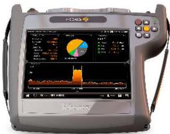
Zur Demodulation eines DAB-Kanals mit Messungen der Signalqualität wie MER und CBER und umfassenden Informationen über die angebotenen Dienste: Radio Info: ( PTY, Service, Modus, Audio, Audio-Bitrate). Zur Leistungsmessungen mit Eingangspegeln zwischen 20 dB $\mu$ V und 128 dB $\mu$ V, C/N und MER.
