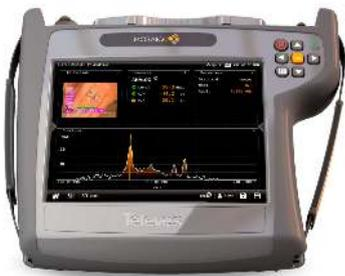
Zur Anzeige und Messung von analogen TV-Kanälen (z.B. in analogen Kopfstationen). Die Funktion ermöglicht die Messung von Signalpegeln zwischen 20 dB $\mu$ V und 128 dB $\mu$ V, C/N bis 52 dB und V/A bis 30 dB.
