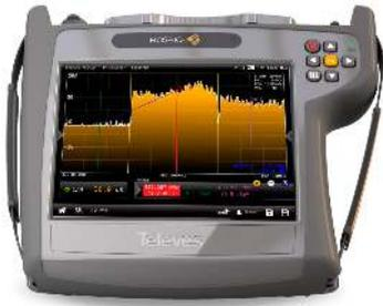
Professioneller Spektrumanalyzer mit ultraschneller digitaler Verarbeitung (Sweepzeit < 10 ms) und hohem Dynamikbereich (> 50 dB). Ausgestattet mit erweiterten Funktionen zur Erkennung und Analyse von Signalen im Bereich von 5 MHz bis 3.300 MHz (Wasserfalldiagramm, Ereignisauslöser, Marker, etc.).
