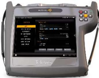
Auf dem MOSAIQ6 können mehrere Benutzerprofile gespeichert werden – je nachdem welche Installation gemessen werden soll. So werden die Parameter einmal definiert – und müssen nicht jedes Mal aufs Neue eingegeben werden. Danach einfach das Profil auswählen mit dem gearbeitet wird und alle Parameter werden am Messgerät automatisch eingestellt.
