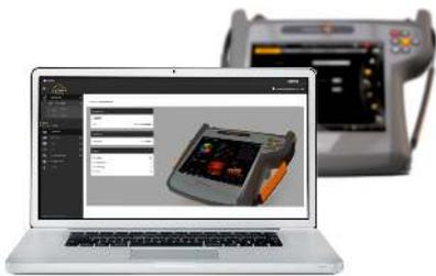
Die zentrale Verwaltung aller in der Cloud registrierten Messgeräte kann über eine einzige Webschnittstelle erfolgen, die von jedem internetfähigen Gerät aus zugänglich ist. Dank dieses Portals kann der Installateur in Echtzeit verbunden werden, entweder um die Geräte zu konfigurieren oder um die letzten Messungen zu überprüfen und zu dokumentieren.
