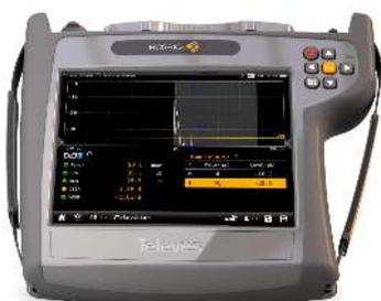
Bei der Erfassung von DVB-T und DVB-T2 Signalen ist es von größter Wichtigkeit, darauf zu achten, dass es keine Echos gibt, die Probleme beim Empfang der Signale verursachen können. Das MOSAIQ6 ermöglicht die Visualisierung der Echos des empfangenen Signals, was es dem Installateur erlaubt, diese Echos bestmöglich zu minimieren, um einen optimalen Signalempfang zu erreichen.
