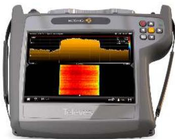
Signalpegel werden farblich auf der Zeitachse dargestellt (siehe Abbildung). Der perfekte Helfer für kurze Signalinterferenzen oder Fading-Analysen, deren Beobachtung schwierig wäre, wenn man nur auf das Spektrum zurückgreifen würde.
