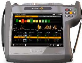
Schließen Sie das Eingangssignal an Ihr MOSAIQ6 an, und innerhalb weniger Sekunden erfasst das Messgerät automatisch das Signal. Das Gerät sucht zuerst nach dem Übertragungsstandard und dann nach allen dazugehörigen Parametern.
