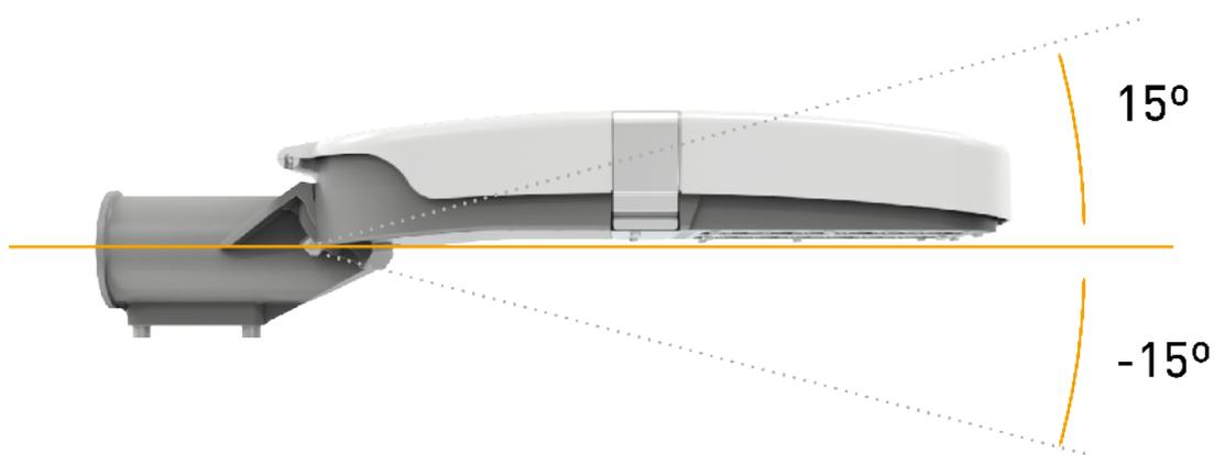
Abertura superior sem a necessidade de ferramentas para aceder ao módulo eletrónico e módulo LED. Sistema de segurança que desliga automaticamente a energia elétrica em caso de abertura de forma a minimizar o risco de eletrocussão.
