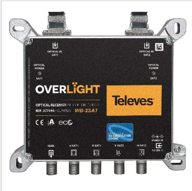
Optischer WideBand Rückumsetzer für Overlight mit 2 x SAT+TERR-Eingänge und 2 x WB-Ausgänge + 1 x TERR-Ausgang, OLC integriert
